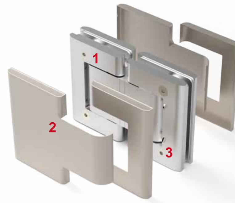
**N.B.** Lo speciale trattamento di ossidazione con alti spessori (25 micron), e il rivestimento dell'intera superficie con copertine in acciaio inox aisi 316, hanno consentito resistenze alla corrosione strepitose, oltrepassando la soglia della 500 ore in nebbia salina/acetica (secondo le norme UNI ISO 9227 AASS Acetic Acid Salt Spray), senza mostrare alcun segno di imperfezione.
