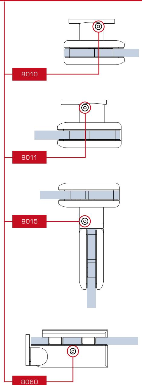
Le cerniere oleodinamiche, vengono fornite con le valvole di regolazione completamente chiuse. (a porta montata infatti, essa non potrà chiudersi).
