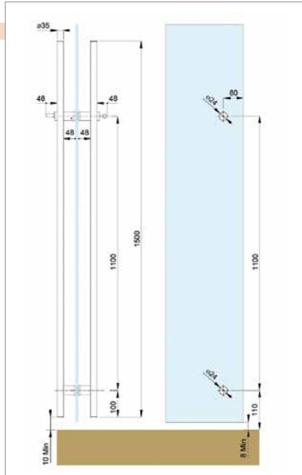
Maniglioni tubolari tondi (Ø 35mm - Spessore 1mm) in acciaio inox; serratura incorporata. Realizzati nelle finiture: lucida o satinata e disponibili in due lunghezze. Una versione da 1500mm nelle varianti: chiave-chiave o chiave-pomolo, e una da 2200mm nella versione chiave-pomolo.
